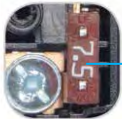
mit gängiger Flachstecksicherung
