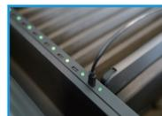
Verbinden Sie die USB-Kabel zunächst mit den USB-Ports und anschließend mit den Geräten.
