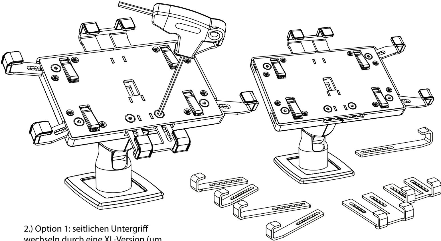
2.) Option 1: seitlichen Untergriff wechseln durch eine XL-Version (um Zentralisierung zu optimieren Position der Tablette; oder besser Position der Griffe in Bezug auf Tasten der Tabletten)
