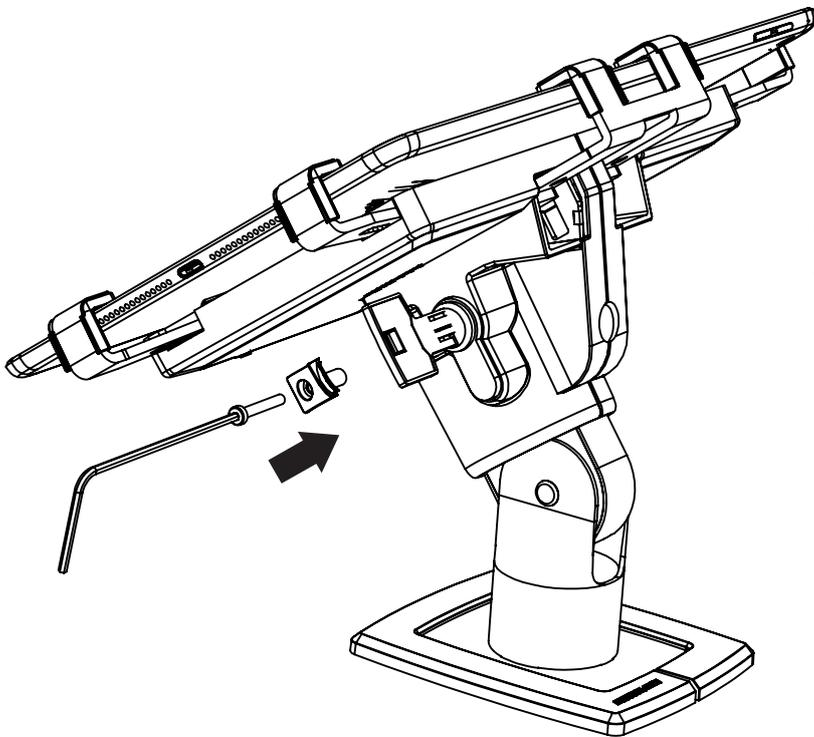
6.) Ersetzen Sie die Kleine Kappe mit einem 2mm Inbusschlüssel
