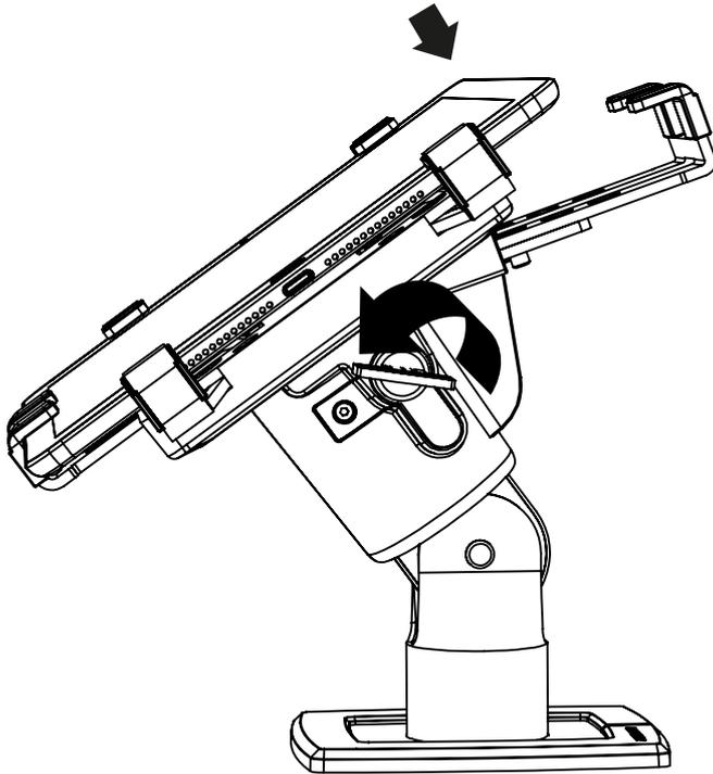
1.) Drehen Sie den Schlüssel nach links (gegen die Uhrzeit ein) zu entsperren.
