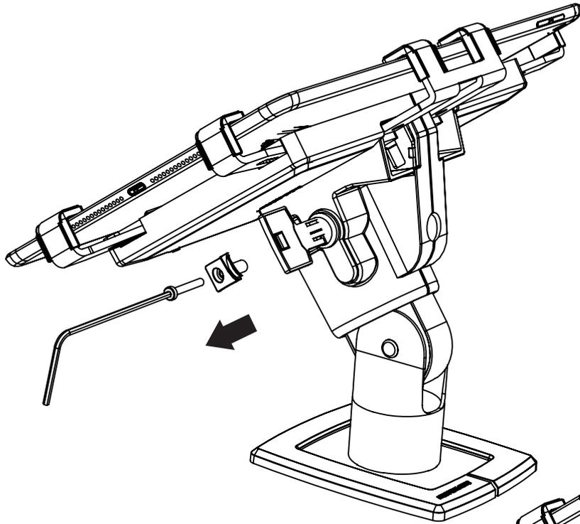
1.) Entfernen Sie die Kleine Kappe mit einem Inbusschlüssel (2 mm)
