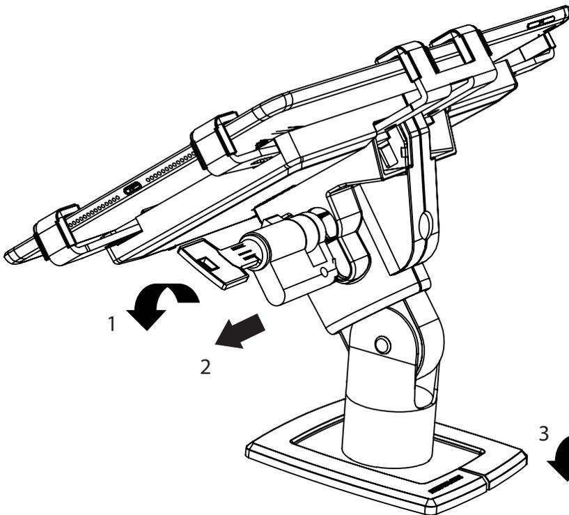
3.) Drehen Sie den Schlüssel ach links. Behalte es Fest gegen den Uhrzeigersinn (1) und zieh das Schloss heraus mit dem Schlüssel dazu (2)
