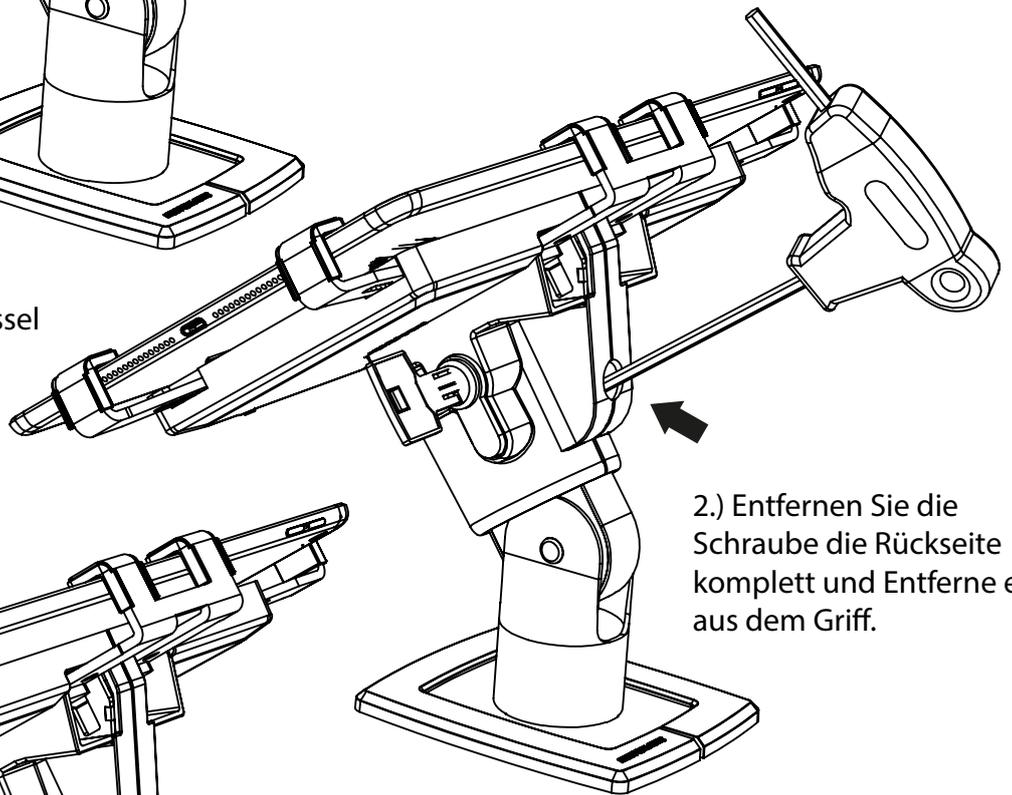
2.) Entfernen Sie die Schraube die Rückseite komplett und Entferne es aus dem Griff.
