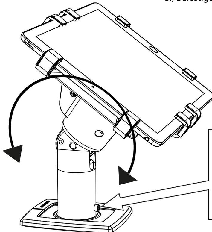
Gripzo T POS 360 und Gripzo T POS haben eine Schraub Einsteller zur Einstellung der Spannung von die Schwenkfunktion. Verwenden Sie den Inbusschlüssel (3 mm)
