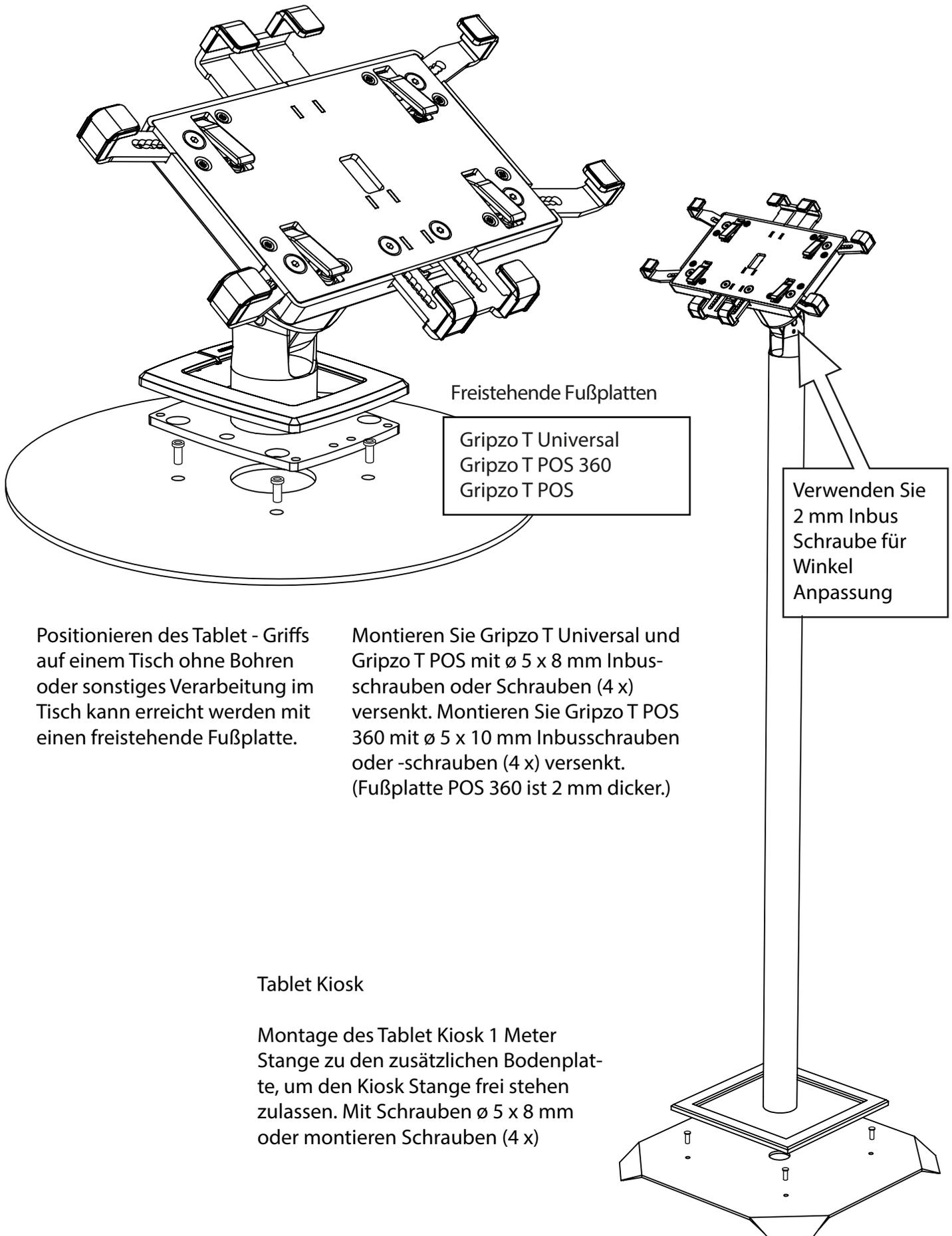
Positionieren des Tablet - Griffs auf einem Tisch ohne Bohren oder sonstiges Verarbeitung im Tisch kann erreicht werden mit einer freistehende Fußplatte.
