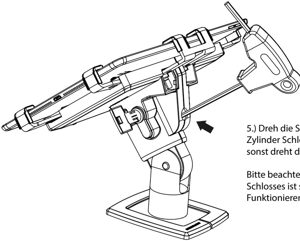
5.) Dreh die Sicherungsschraube in das Zylinder Schloss und mach dass nicht zu eng sonst dreht das Schloss nicht gut.
