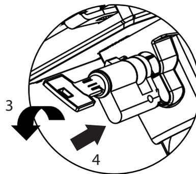
4.) Platzieren Sie das neue Zylinder Schloss, halten Sie den Schlüssel gegen im Uhrzeigersinn (3) und drücken Sie es durch die Öffnung (4)
