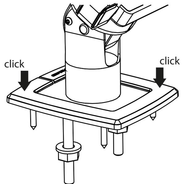
Option 1.) Montieren Sie die Schrauben durch die Grundplatte
