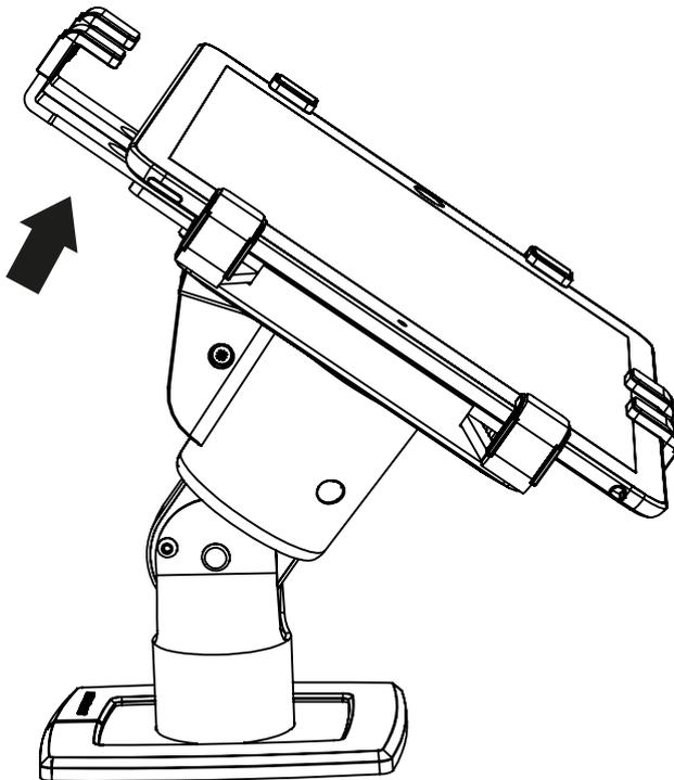
2.) Überprüfen Sie, ob einzelne Griffe die Tablet abdecken/sichern Stellen Sie sicher, dass das Tablet nicht zu fest ist eingeklemmt! Lassen Sie einen Abstand von 2 mm.
