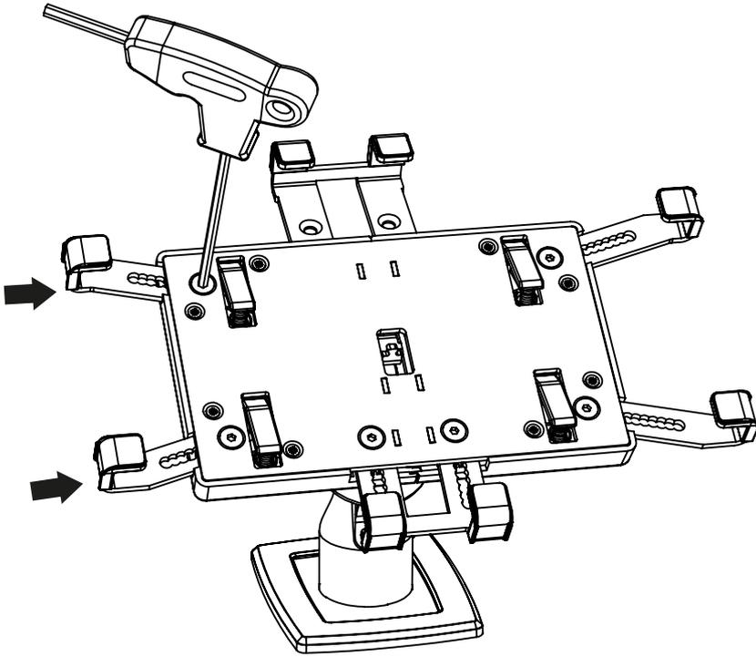
2.) Montieren Sie links und rechts gleich sodass den Gerät in der Center ist.
