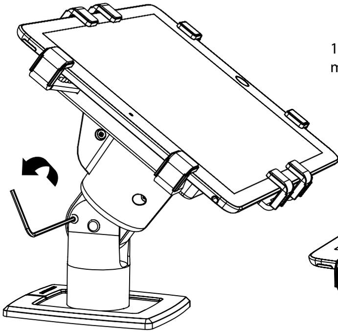
1.) Lösen Sie die Inbus Schraube an der Stange mit einem Inbusschlüssel # 2 mm.
